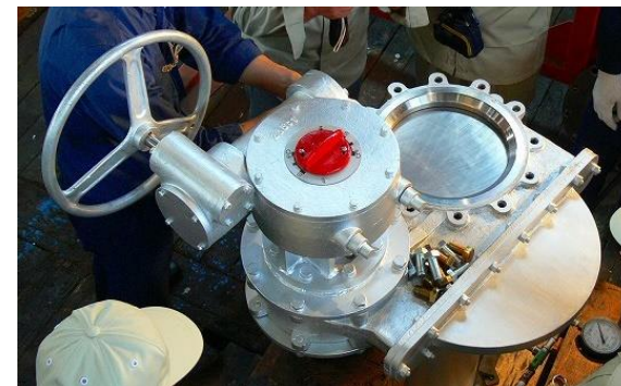
発電所向けに特別な駆動部を装着
