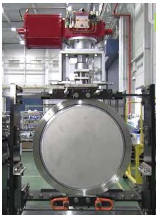
高さ2.3m、重さ1.2tの船舶排ガス用バルブ
