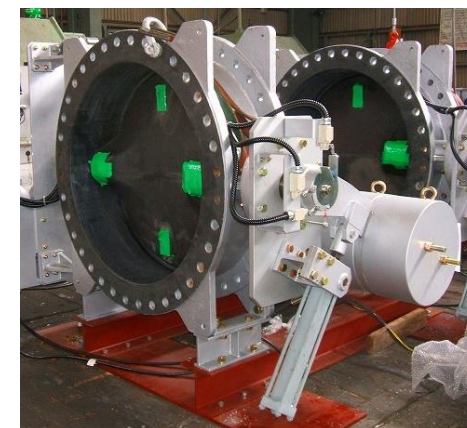
発電所向けに特別な駆動部を装着
